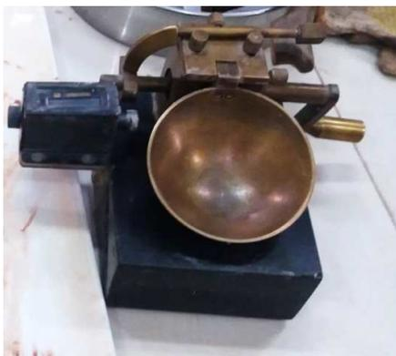
Gambar 2. Alat Casagrande dalam pengujian Atterberg Limit
